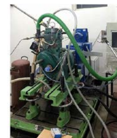
图3. 测试设备内的双燃料发动机
