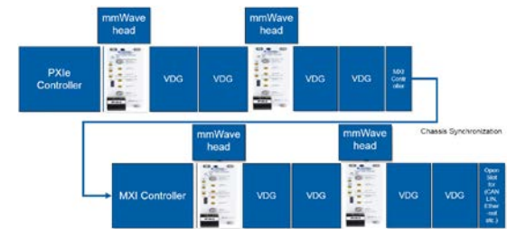
图2.包含八个目标和四个到达角的系统架构
