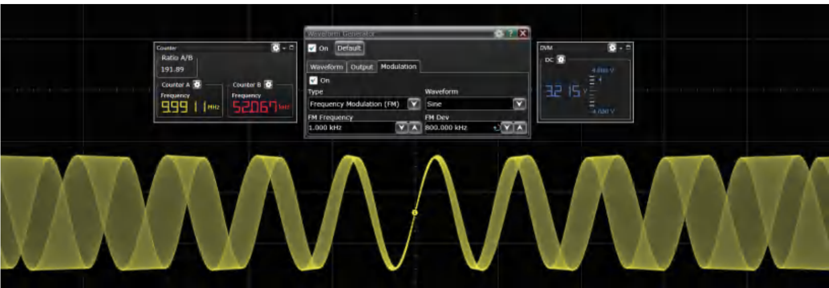
生成频率调制的 10 MHz 正弦波，同时使用计数器测量两个信号的频率，并使用 DVM 测量第三个信号的直流电压。请注意，使用计数器和 DVM 时无需激活通道。
