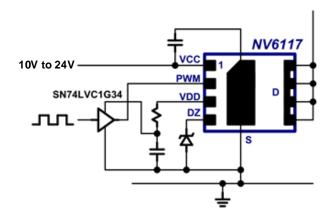
Fig. 26. 3.3 V PWM input buffer circuit
